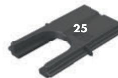
Längs-Verbinder für die Längsverbindungen zwischen zwei VersiFrame Profilen. Bitte immer einen Abstand von mind. 5mm zwischen zwei Längsprofilen beim Stecken einhalten, um Probleme aufgrund der Ausdehnung zu vermeiden.
