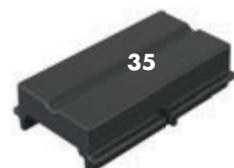
Längs-Verbinder für die Längsverbindungen zwischen zwei VersiFrame Profilen. Bitte immer einen Abstand von mind. 5mm zwischen zwei Längsprofilen beim Stecken einhalten, um Probleme aufgrund der Ausdehnung zu vermeiden.
