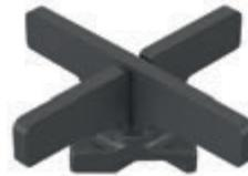
Fugenkreuze sind für Fugenbreiten von 3mm, 4mm und 8mm erhältlich. Sie ermöglichen einen gleichen Abstand zwischen den Platten. Zwei gegenüberliegende Stege können für Längs- und T-Fugen abgetrennt werden.
