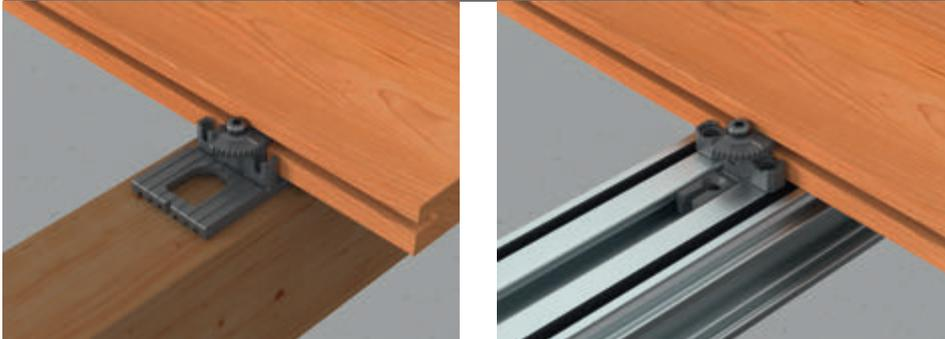
Dielen können entfernt und wieder montiert werden. Der Exzenter kann durch das Lösen der Schraube um ein Viertel gedreht werden, um die Diele zu entfernen.
