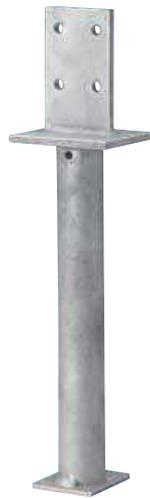
**Einteiliger einbetonierbarer Stützenschuh mit Schwertaufnahme (T-Form) und 300 mm langer Rohrdolle mit Druckplatte für mittlere Konstruktionen mit höheren Spritzschutzanforderungen wie z.B. Carports, Balkonpfosten.**
